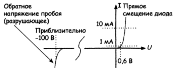
Рис. 3N.20. Графики вольт-амперных характеристик диода: величина тока при обратном напряжении лежит в наноамперном диапазоне
