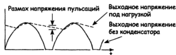
Рис. 3N.29. Форма напряжения на вторичной обмотке трансформатора
