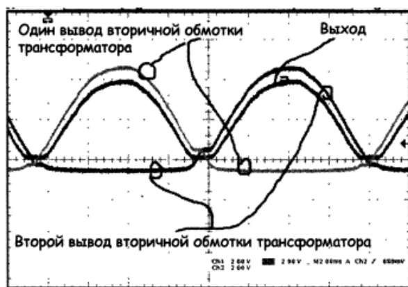
Рис. 3N.23. График выходного сигнала двухполупериодного мостового выпрямителя
