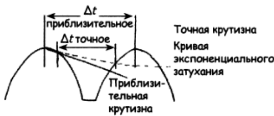
Рис. 3N.31. Временные параметры сигнала пульсаций
