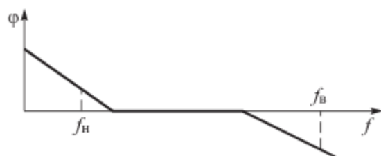
Рис. 2.6. Фазочастотная характеристика усилителя \varphi(f) :
