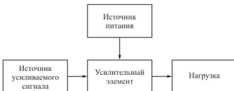
Рис. 2.1. Обобщенная структурная схема усилителя
